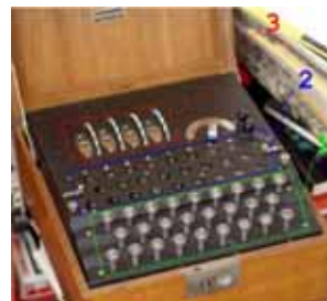
Macchina cifrante Enigma a quattro rotori
