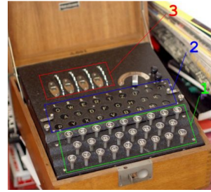
Macchina cifrante Enigma a quattro rotori
